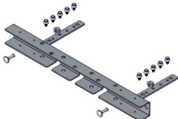
Fästjärn monteras mot fäste för takstege med vagnsbult M10x30 alt. M10x20 och M10 mutter. Fästjärn skruvas på takplåten med 5 st 6,3x19 mm själv-gängande skruv per fäste. Alt. med 5 st 6x35 mm trä-skruv direkt mot tak med papp/råspont.
