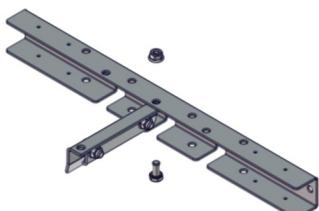
Montera ihop fästet med falsfästet med 1 st M10x20 och M10 mutter. Montera falsfästet på takfältsen och dra åt klämbacken med min 20 Nm. Klämbacken skall greppa runt den dubbelvikta kanten.
