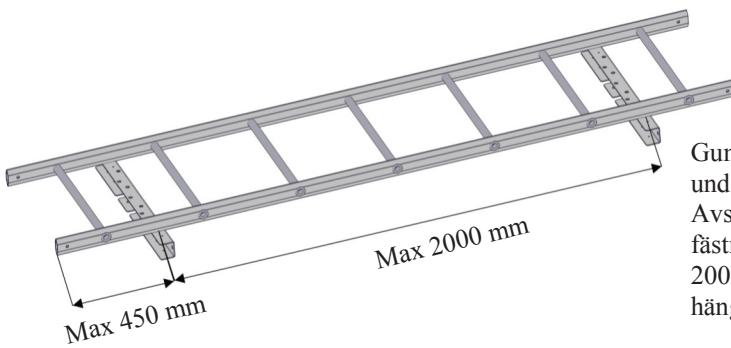
Gummilist limmas på undersida stegfäste. Avstånd mellan infästningar i tak max 2000 mm, max överhäng 450 mm.
